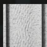
À proximité des ourlets et des coutures, en raison de la double couche de tissu, des épaisseurs variables peuvent apparaître sur le rouleau de tissu. Cela peut entraîner des tensions du tissu et donner lieu à des ondulations.
